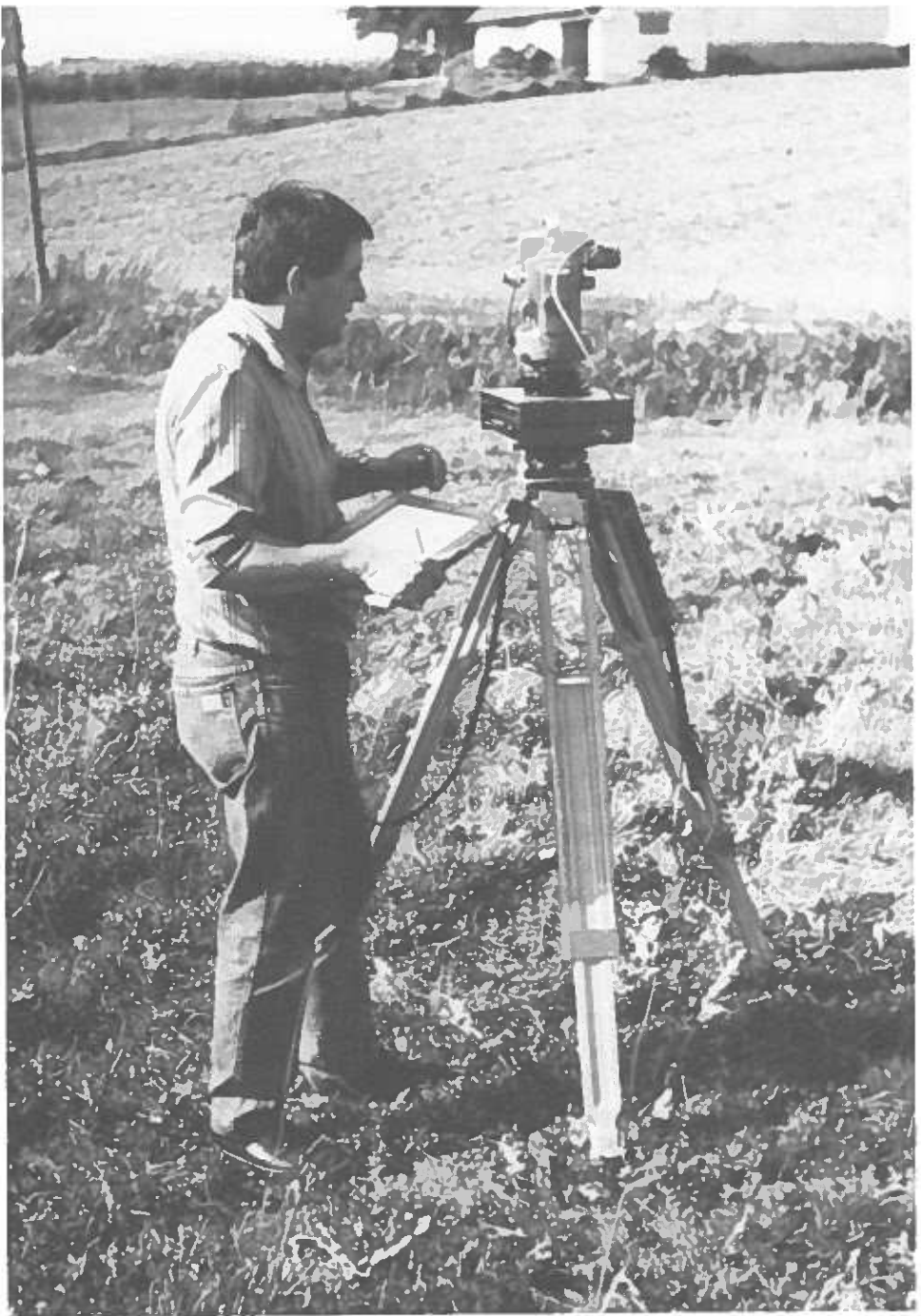
Weitere Vermessungen zum Rohrlegen · am Theodolit
